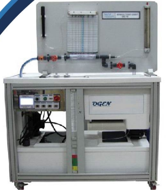
Hidroloji Ana Üniteyle Kullanılan OAG-140 Modül Tip Bernoulli Deney Seti
